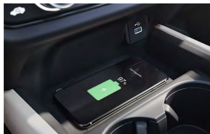
Carregador sem fio Honda: o carregamento por indução
